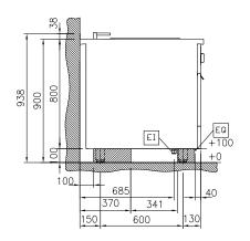
Drain Electrical inlet (power) Equipotential screw Water inlet
